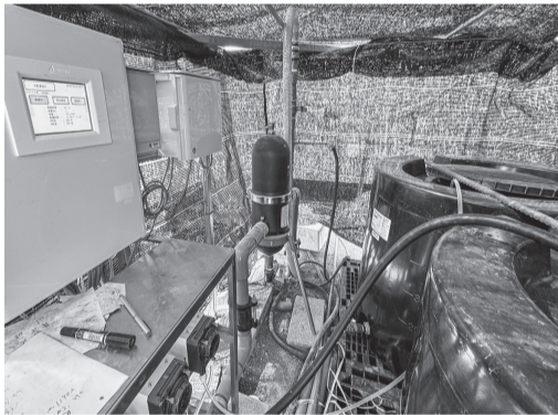
自動灌水装置。日射量に応じて灌水する
