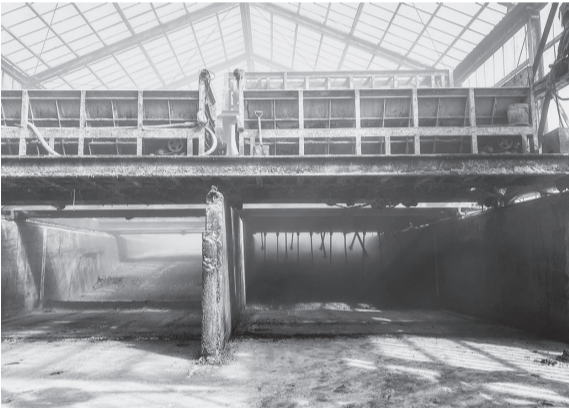
写真右側の大型攪拌機で切り返しを行い、発酵を促進する
