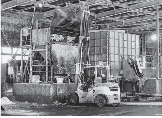
現在40~50トンの生ごみが搬入され、異物除去を最初に行って粉碎する
