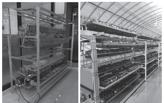
室内設置例（小型タイプ） 鉢物やキノコ栽培も可能 サイズ=W70×D192×H198 重量=80 kg
